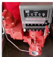
Der «Heizöl-Quick» kann bei Bedarf auch mit einem eichfähigen Zähler ausgerüstet werden.
