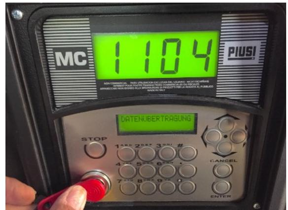
SKOR<sup>sys</sup> avec unité de commande, installé à la citerne (Accès par clé électronique personnelle); évaluation par clé spéciale et ordinateur; version standard pour 80 utilisateurs; version spéciale pour 120 utilisateurs.
