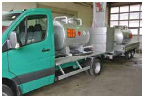
A droite: transformation d'une citerne existante montée sur un nouveau véhicule.
