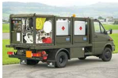
A droite: petit véhicule de ravitaillement pour le jet A-1, respectivement AVGAS, engagé sur un aéroport.
