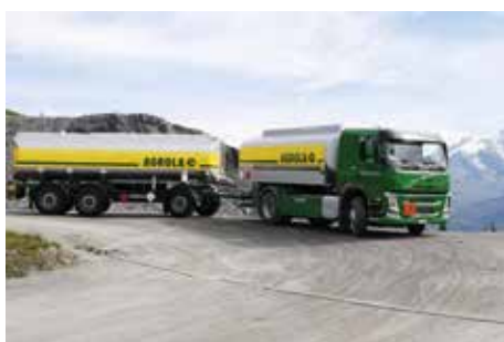
Trains routiers pourvus de cuves multiples pour le ravitaillement combiné des stations-service.
