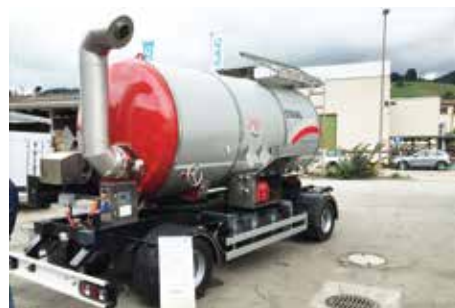
Remorque avec chauffage autonome pour le transport de bitume.
