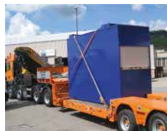
... citerne spéciale construite sur mesure (pour salle de commande résistante aux séismes).
