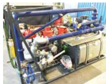
...module de transvasage pour le transport ferroviaire d'huile de chauffage et de carburant.
