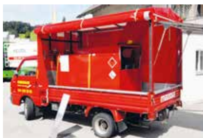
IBC-BT 1000 pour le transport d'urgence d'huile de chauffage (tuyau de fourniture long de 40 m).
